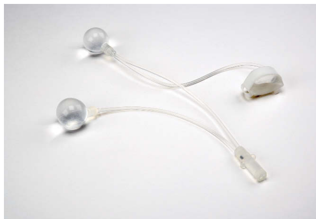
Figura 1 – Esfínter urinario FlowSecure donde se observan los reservorios regulador de presión y de asistencia al estrés (que se sitúan en zona perivesical), manguito (que se sitúa envolviendo la uretra) y bomba de control (que se sitúa en la bolsa escrotal).
